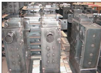
Gotowe korpusy czekają na kolejny etap montażu
