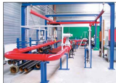
Stacja badania armatury
